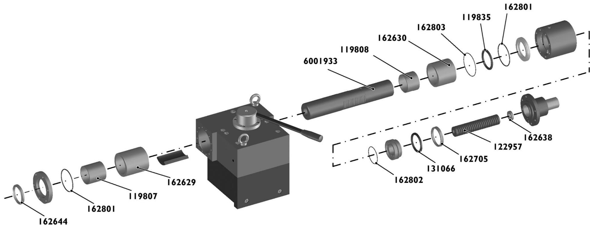
**Reitstock verstärkt mit Pneumatikrückzug    Contre-poupée renforcée, rétraction pneumatique    Reinforced tailstock, pneumatic sleeve retraction**
