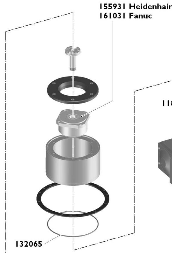
**B-Achse mit Direktantrieb   Axe B à actionnement direct   B-axis with direct drive**
