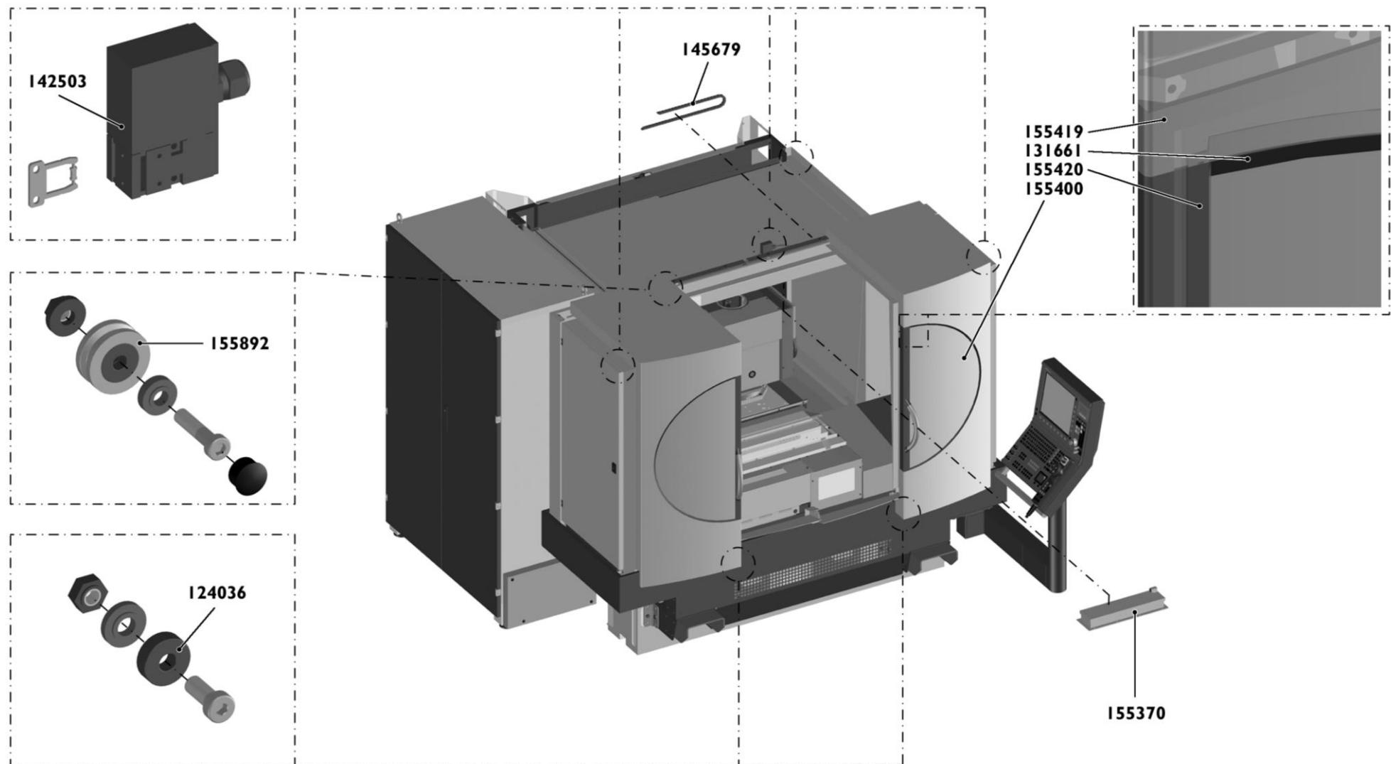
**Verschalung elektrischer Schiebetürantrieb****Capotage entraînement électrique des portes coulissantes****Cabinet electric sliding door drive**
