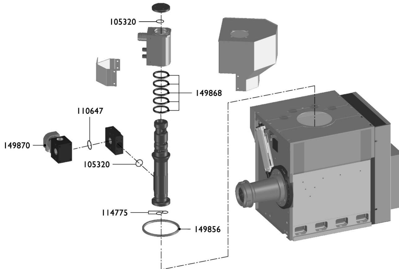
**8.5 ÖL/Luft – Schmieraggregat    Groupe de graissage huile/air    Oil/air lubrication unit**
