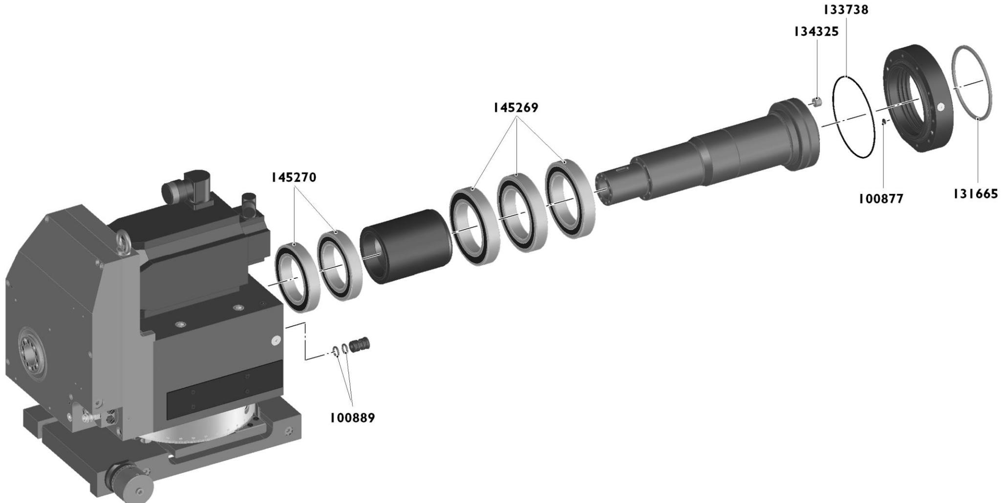
**Werkstückspindelstock verstärkt    Poupée porte-pièce renforcée    Reinforced workhead**
