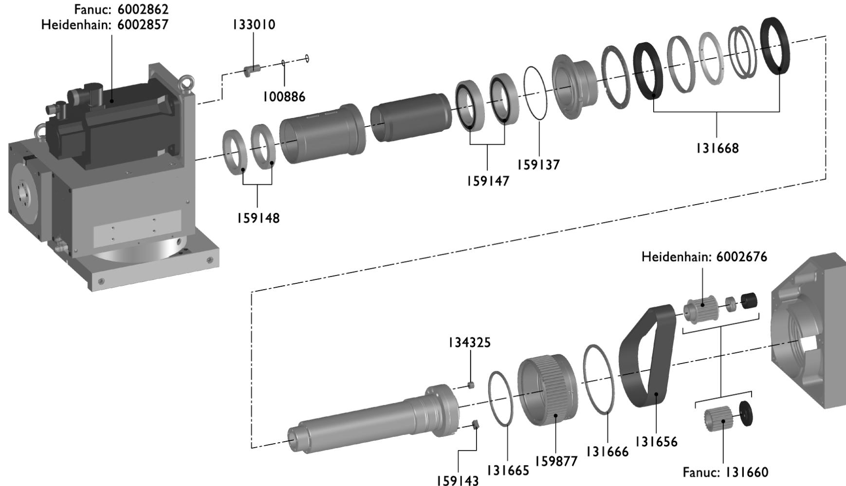
**Werkstückspindelstock Standard (Keilriemen) Poupée porte-pièce standard (Courroie trapézoïdal) Workhead standard version (V-belt)**
